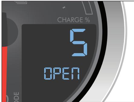
Pendant la période de compte à rebours, appuyez une fois (une longue pression) sur le bouton de déverrouillage du compartiment de rangement de la batterie situé sur l'interrupteur du guidon côté gauche pour déverrouiller le compartiment de rangement de la batterie. Tirez la poignée vers l'extérieur pour ouvrir le compartiment.
