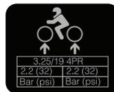
**Étiquette de pression des pneus :** L'étiquette est située sur le bras oscillant du côté gauche. Elle identifie la taille recommandée des pneus et les pressions de gonflage.
