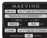
**L'étiquette réglementaire :** L'étiquette est située sur le côté gauche de la tête de direction sur le cadre du véhicule. Elle identifie le type de véhicule, le numéro d'identification du véhicule (NIV), le poids, la puissance et la vitesse maximale.
