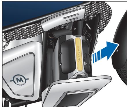
Pour installer la batterie principale, ouvrez le compartiment de rangement de la batterie principale et soulevez soigneusement la batterie, puis abaissez-la en position.
