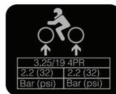
**Reifendrucketikett:** Das Etikett befindet sich auf der linken Seite der Schwinge. Es kennzeichnet die empfohlene Reifengröße und den Reifendruck.
