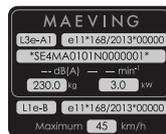
**Das Typenschild:** Das Typenschild befindet sich auf der linken Seite des Lenkkopfes am Motorradrahmen. Es identifiziert Fahrzeugtyp, Fahrzeugidentifikationsnummer (VIN), Gewicht, Leistung und Höchstgeschwindigkeit.
