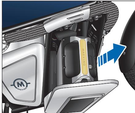
Um die Primärbatterie einzubauen, öffnen Sie das Aufbewahrungsfach der Primärbatterie und heben Sie die Batterie vorsichtig an und senken Sie sie in die richtige Position ab.
