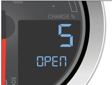
Drücken Sie während des Countdowns einmal (lang) die Entriegelungstaste des Batterieaufbewahrungsfachs auf der linken Seite des Lenkerschalters, um das Batterieaufbewahrungsfach zu entriegeln. Ziehen Sie den Griff nach außen, um das Fach zu öffnen.
